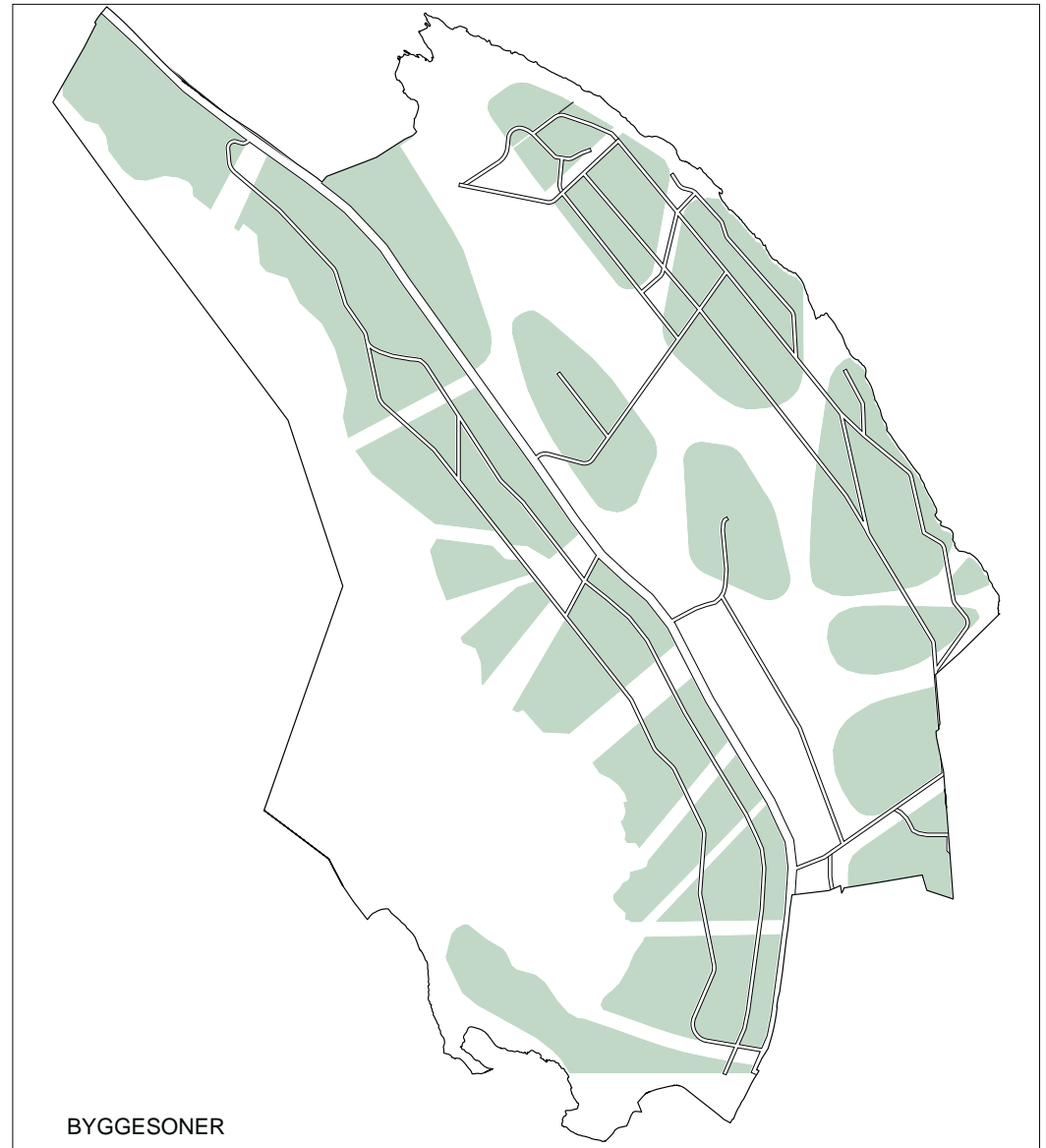
Initierende planskisse av forslagets byggesoner og transformasjonsområder tilrettelagt med vekt på at det bygges på fjell.
